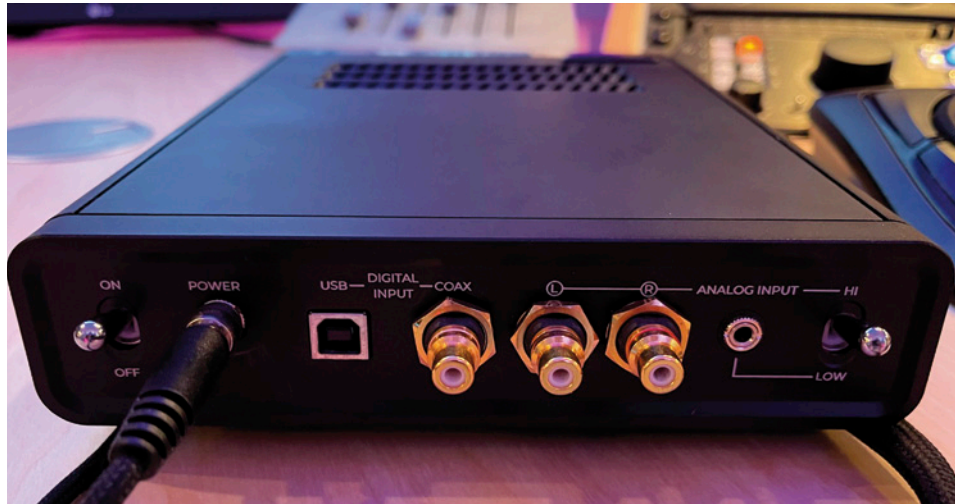
Auf der Rückseite befindet sich die gesamte Eingangsanschlusstechnik: USB und SPDIF koaxial, analoge Eingänge für links und rechts unsymmetrisch auf Cinch sowie ein Miniklinken-Eingang, der wahlweise geschaltet werden kann
