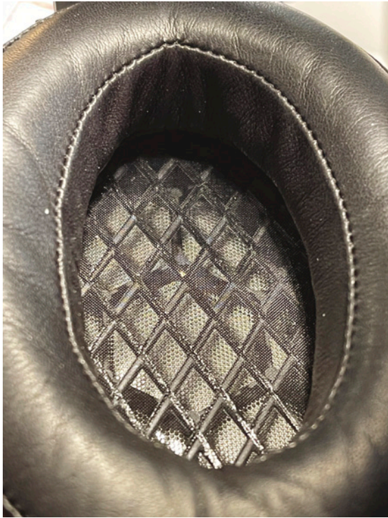
Auf beiden Seiten ist die Membran von der Wabenstruktur segmentiert. Die Innenansicht legt den Blick auf das neue Lochmuster frei
